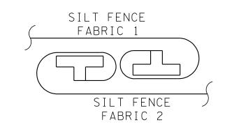
1) POSITION THE SILT FENCE FABRIC 2 POST INSIDE OF THE SILT FENCE FABRIC 1 POST AS SHOWN ABOVE.
