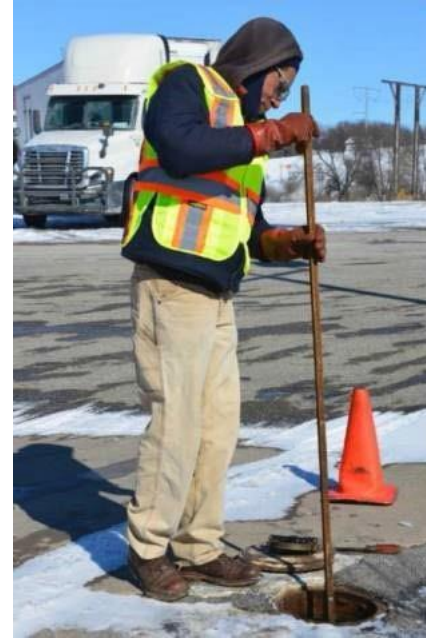
在既定时间段的开始和结束时测量罐中的液位。
