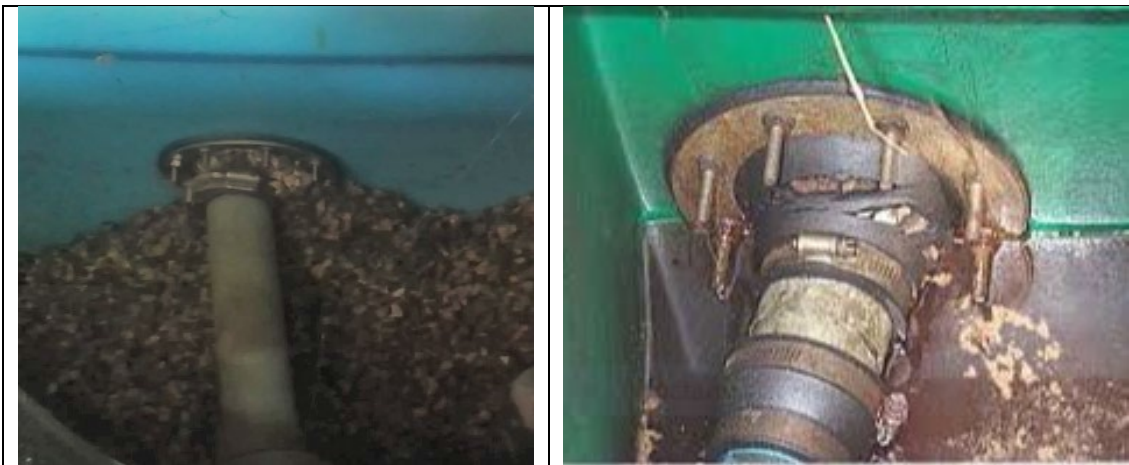
وئەكەنى سەرەو كەرەستەى چوونەناو ەو ەى تىكچو و نىشان دەدەن كەوا رىگە بە زىخ دەدات بچىتە ناو حموزەكە. حموزەكە چى تر رىگرىكەر نىھ لە شلە.
