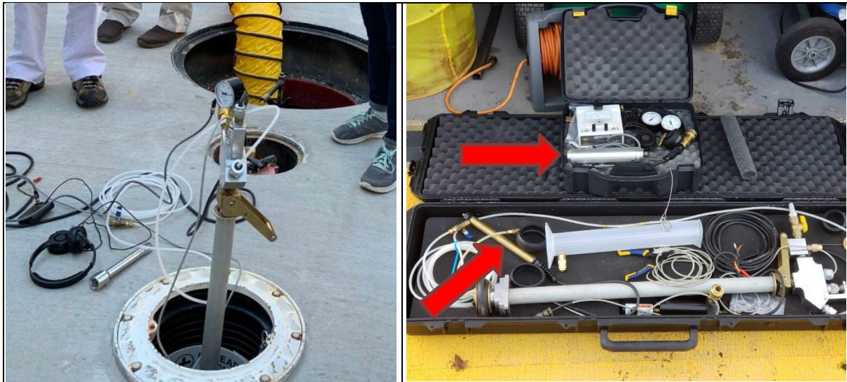
وینەى نامرازى تاقىکردنەوى Mesa Engineering's 2-D لە سەرەویە. تیببىنى ماىكرو فۆنەكە (تبرى سەروو) و سىنسىەرى ئاو (تبر خوارەو) ى لای چەپى سەرەوى وینەكە بکە.
