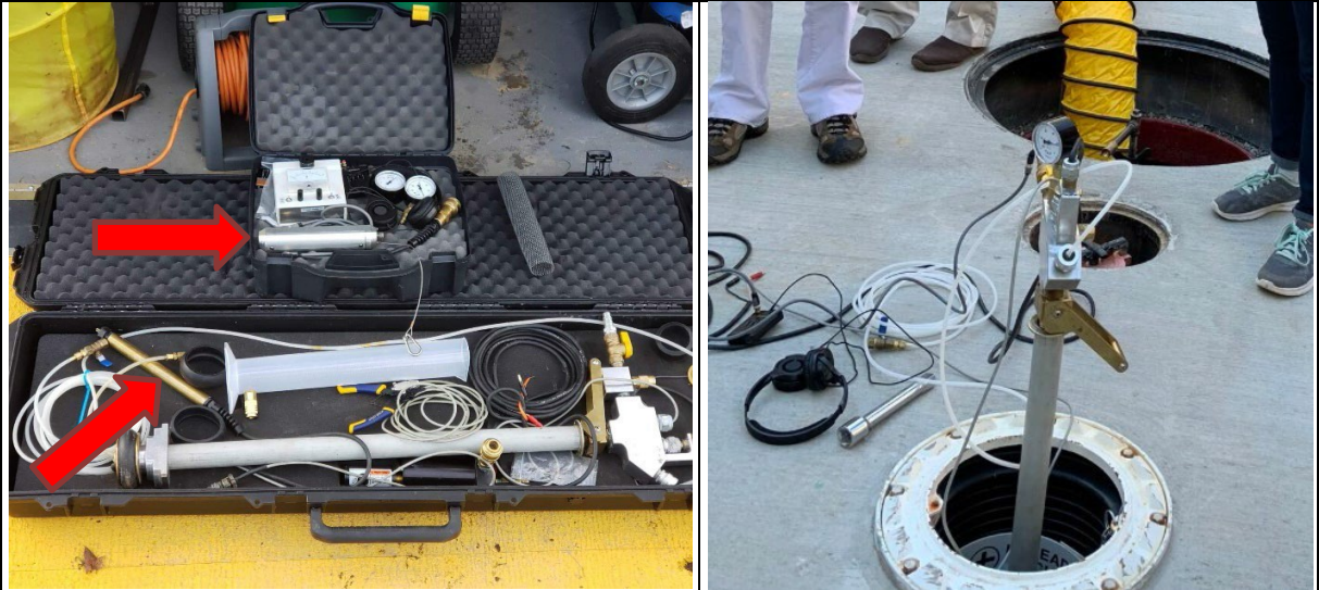
Mesa Engineering 의 2D 테스트 장비는 위의 그림입니다. 왼쪽 위 사진에서 존데(위쪽 화살표) 및 물 센서(아래쪽 화살표)를 확인하십시오.
